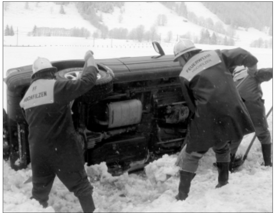
Bei der Bergung des Fahrzeuges, bzw. auf die Räder stellen um Auslaufen von Flüssigkeiten zu verhindern. (Foto Eder Claudia)
